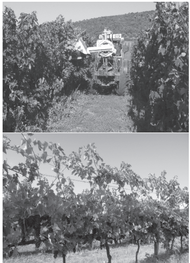
Fig. 6 - Defogliatrice meccanica in azione su Sangiovese e particolare della chioma dopo il passaggio della macchina operante nella parte alta della chioma circa quattro settimane prima della vendemmia.
