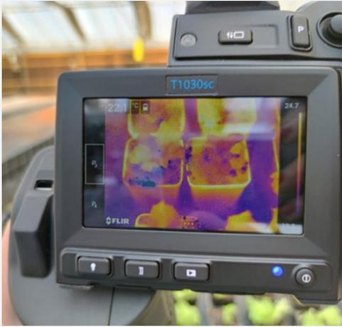
**Camera termica Flir T1030sc** con range spettrale 7.5-14  $\mu\text{m}$ , risoluzione 1024x768 pixel, sensibilità termica <20 mK a 30 °C e frame rate 30 Hz in camera, per acquisizioni in passivo.
