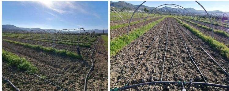
L'impianto di microirrigazione è dotato di due differenti tipologie di ali gocciolanti (Blu e Gialla) che si differenziano per la presenza di due differenti composti antimicrobici che contrastano la formazione di biofilm.
