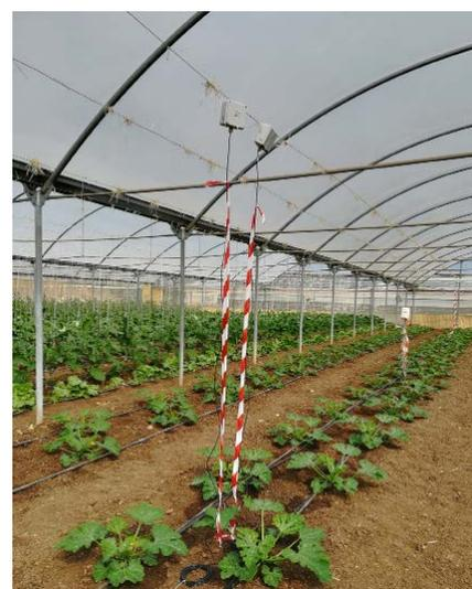
I sensori sono collegati a nodi wireless (posizionati in alto) alimentati a batteria e connessi con l'unità centrale tramite moduli commerciali LoRa
