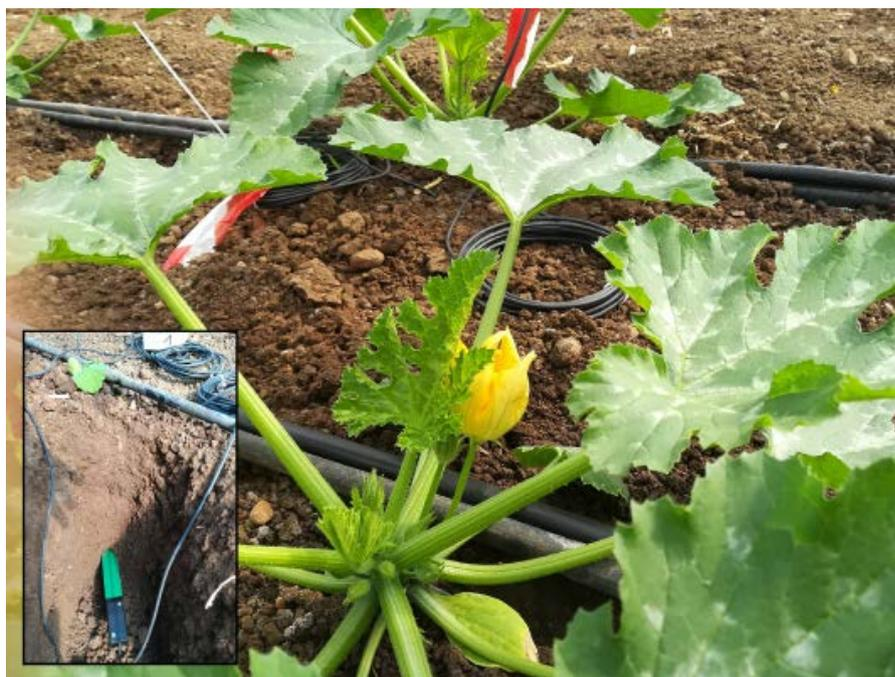
Sensori posizionati nella porzione di suolo esplorata dall'apparato radicale di piante di zucchini, connessi con l'unità centrale tramite nodi wireless basati su moduli commerciali LoRa
