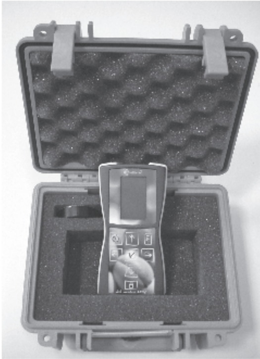
Fig. 1 - DA_Meter, la strumentazione vis/NIR portatile brevettata dall'Università di Bologna.
