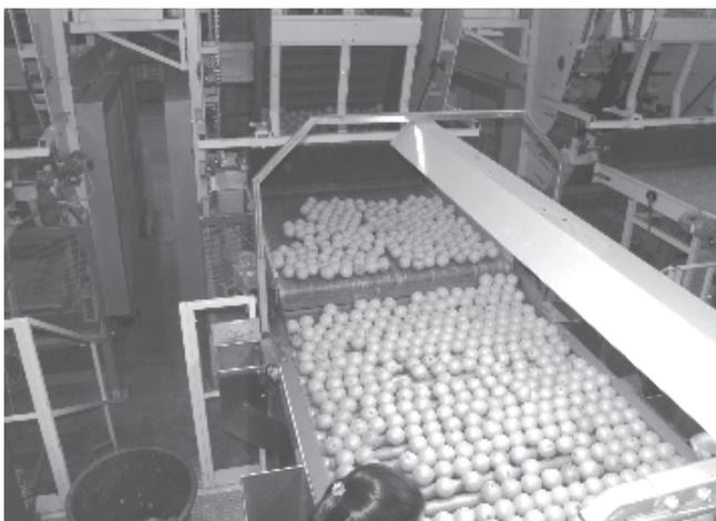
Fig. 2 - Il ribaltatore di bin di recente introduzione nelle linee per agrumi siciliane.
