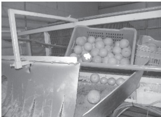
Fig. 1 - Il tradizionale sistema di ribaltamento delle cassette.
