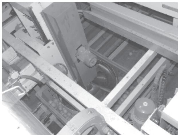
Fig. 3 - Il sistema di riempimento dei bin per limitare le altezze di caduta dei frutti.
