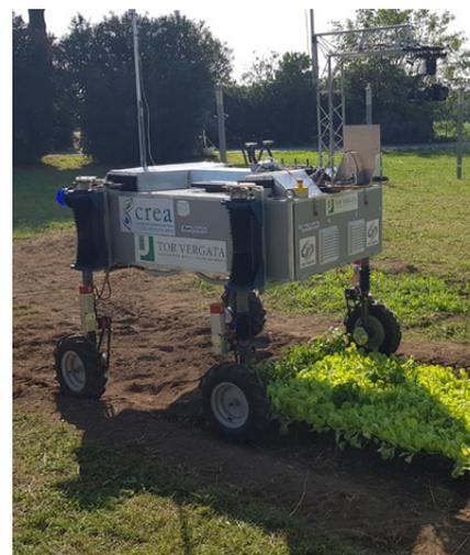
Rover a guida autonoma realizzato nell'ambito del progetto Masaf Agrofiliera coordinato dal Crea - ingegneria e trasformazioni agroalimentari, accessorato con lidar, sensori iperspettrali e multispettrali per il monitoraggio prossimale real-time delle colture
