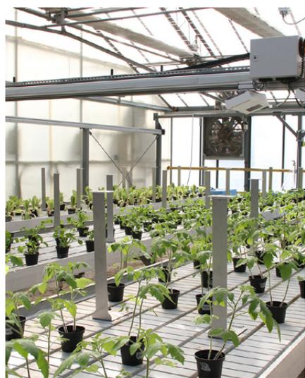
Piattaforma di fenotipizzazione multispettrale 3D Phenospex per l'analisi non distruttiva ed automatizzata delle caratteristiche morfologiche e funzionali di un numero elevato di piante
