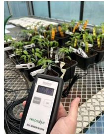
Figura 2. Determinazione del contenuto idrico tramite sensori
