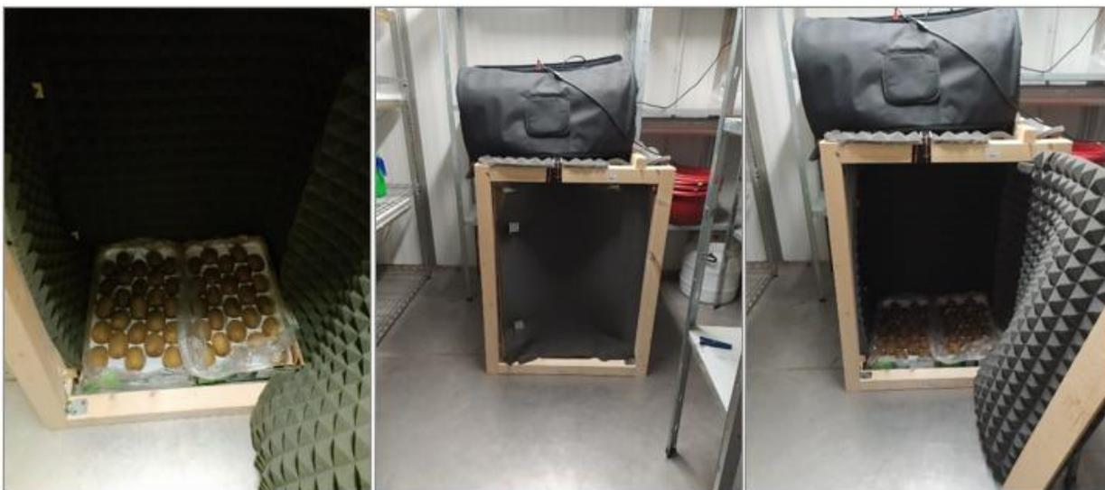
**Figura 1.** Custom-box insonorizzati impiegati per la prova sperimentale.
