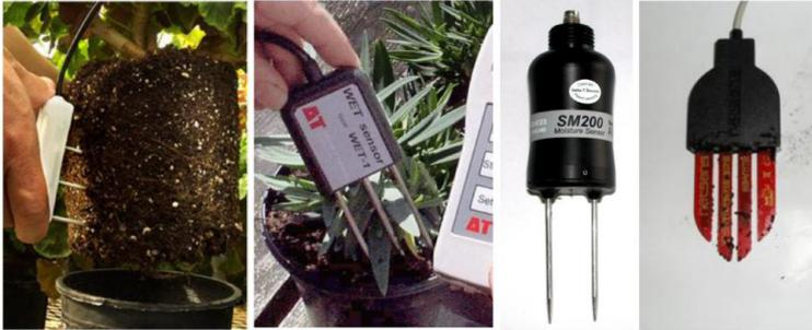
Fig. 4 - Alcuni esempi di sensori dielettrici per la misura del contenuto idrico del substrato: Da destra verso sinistra: solo misura del contenuto idrico del mezzo (Terrasense 2, Netsens e SM200, Delta-T Device;) o anche della bulk EC del mezzo (WET-1, Delta-T Device e GS03, Decagon Device).
